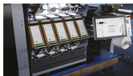
Gestión optimizada de la tinta: Un sistema de gestión de tinta rediseñado, con acceso para el operario, agiliza y simplifica la sustitución de los contenedores de tinta sin riesgo de contaminación.
