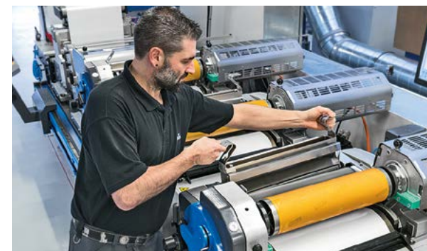
Con unas pocas maniobras, podrá cambiar cómodamente las rasquetas de cámara.
